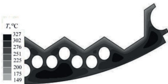
Рис. 3. Температурне поле в момент часу t = 100 с з початку АС
