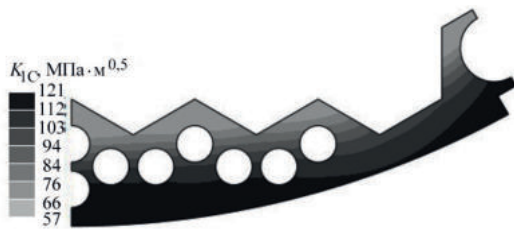
Рис. 7. Розподіл критичних значень КІН в матеріалі вигородки в момент часу t = 100 с з початку АС
