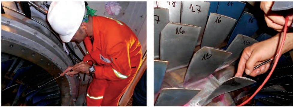
Рис. 12. Експлуатаційний контроль лопаток газової турбіни за допомогою ВСП типу МДФ 0501
