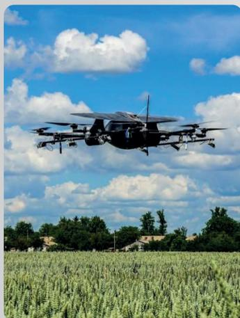
**Проект «СОКРАТ»** — програмно-апаратний пристрій для швидкого виявлення нерозірваних боеприпасів та мін з дистанційного знаходження вибухонебезпечних предметів на базі БПЛА.
