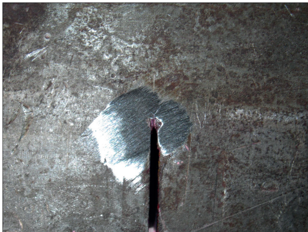
Рис. 5. Приклад тріщини, яка не відповідає розрахунковим математичним моделям
