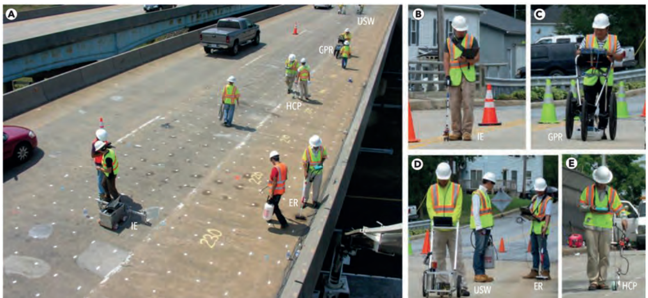
Figure 1. Manual NDE data collection on a bridge deck (a) using the following NDE technologies: (b) impact echo; (IE); (c) ground penetrating radar (GPR); (d) ultrasonic surface waves (USW) and electrical resistivity (ER); (e) half-cell potential (HCP) Рис. 1. Ручний збір даних NDE на настилі мосту (а) з використанням наступних технологій NDE: (б) ударний ехо-метод (ІЕ); (с) георадар (GPR); (д) ультразвукові поверхневі хвилі (USW) і вимірювання електричного опору (ER); (е) гальванічного потенціалу (HCP)
