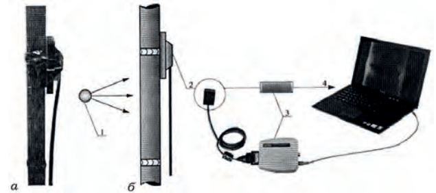
Рентгенотелевізійний контроль стикових з'єднань арматури ( a ) і труб малого діаметра ( б ): 1 – джерело випромінювання; 2 – мініатюрний твердотільний перетворювач; 3 – блок передачі цифрових зображень; 4 – виведення
