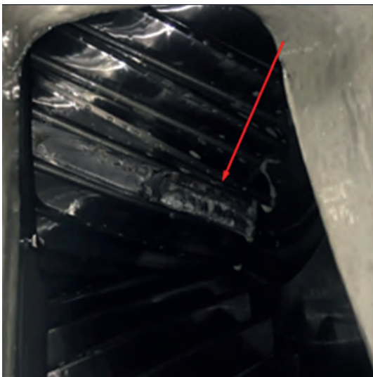
Рис. 15. Фото зуба ведучої шестерні редуктора
