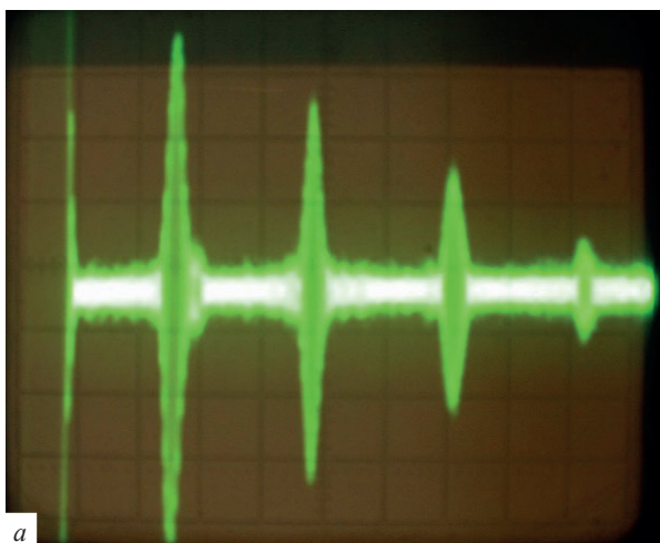
Рис. 2. Часові розгортки з імпульсами поверхневих хвиль, що багаторазово оббігають по периметру трубу діаметром 76 мм з товщиною стінки 4,2 мм (а) та по периметру заготовки діаметром 220 мм (б)
