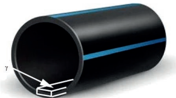
Рис. 3. Напрямок вирізання шліфів \gamma зі стінок поліетиленових труб для проведення структурних та теплофізичних досліджень
