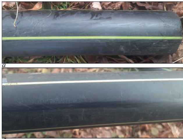
Рис. 2. Зразки поліетиленових труб з PE-80: ST1 (а) та ST2(б)
