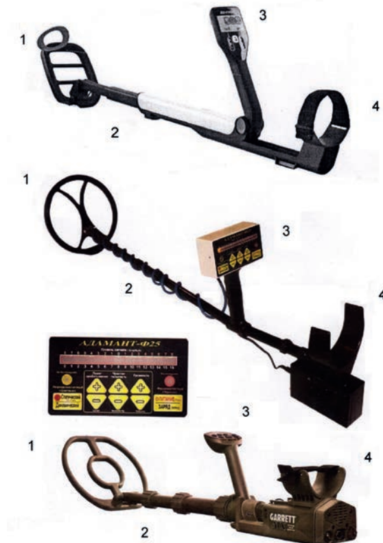
Рис. 2. Ручні міношукачі різних країн: 1 – індукційна котушка; 2 – штанга; 3 – пульт; 4 – кріплення на руці
