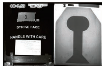
Рис. 2. Зовнішній вигляд (ліворуч) бронепластини та її рентген-телевізійне цифрове зображення (праворуч)
