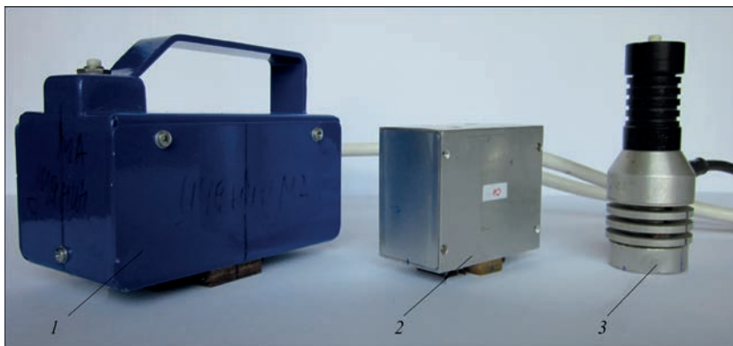
Рис. 3. Приставні МП для локального вимірювання КС: 1 і 2 – П-подібні відповідно 1 і 2 для роботи з МА; 3 – МП приладу типу ИКС-104, який працює за МТП
