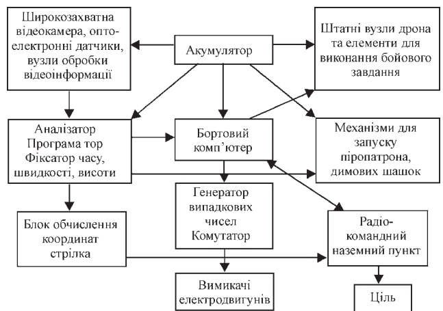
Рис. 3. Блок-схема взаємодії вузлів дрона
