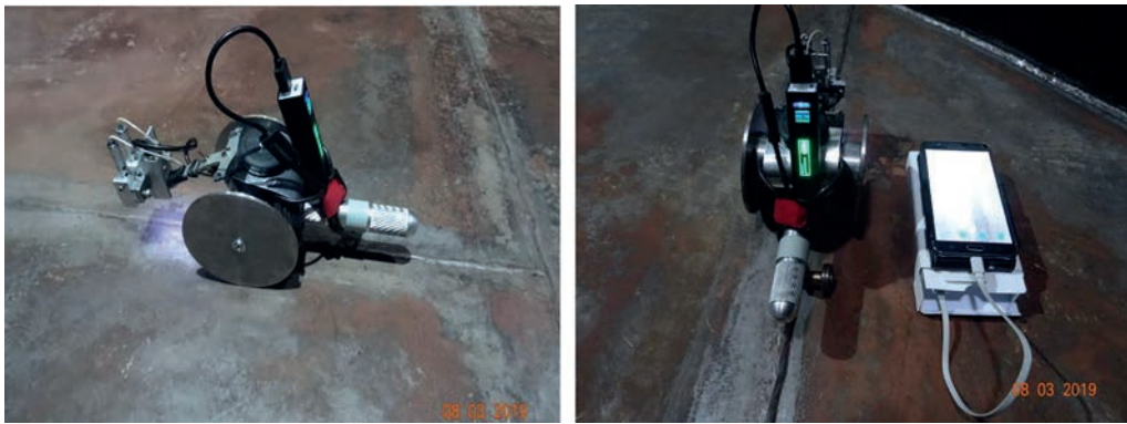
Рис. 5. Випробування пристрою запису візуальної інформації ВИК/ТВА-1 на зварних з'єднаннях днища резервуара РВС-200
