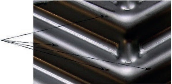
Рис. 1. Ділянка поверхні пластини з ромбовидними потертостями
