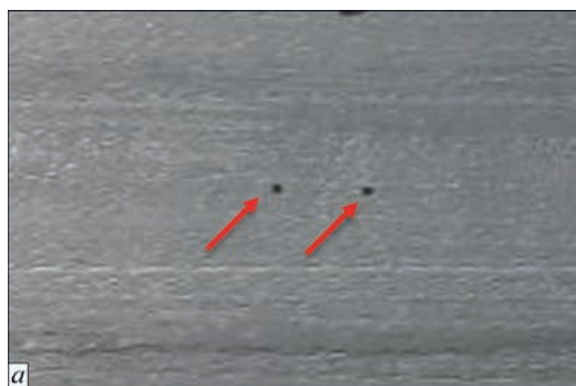
Рис. 8. Широкографічний контроль досліджуваної ділянки зварного шва алюмінієвого зразка: загальний вигляд ділянки з дефектами (a) і типова картина виявлених дефектів діаметром d = 0,3 мм і завглибшки L = 0,35 і 0,85 мм (б)
