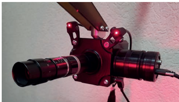
Рис. 2. Зовнішній вигляд широкографічного інтерферометра із лазерними модулями та змінним об'єктивом
