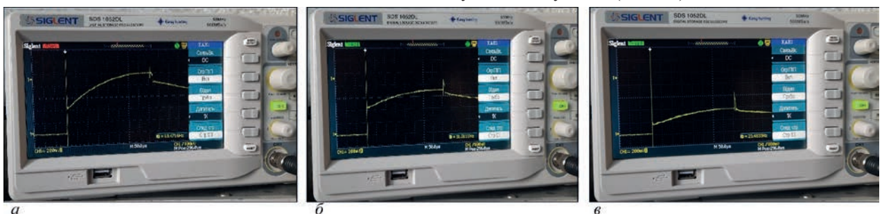
Рис. 7. Струм у котушці намагнічування, еквівалентний магнітному полю, при живленні ключового каскаду напругою, В: а – 30; б – 20; в – 10. Тривалість імпульсу намагнічування 400 \text{ мкс}
