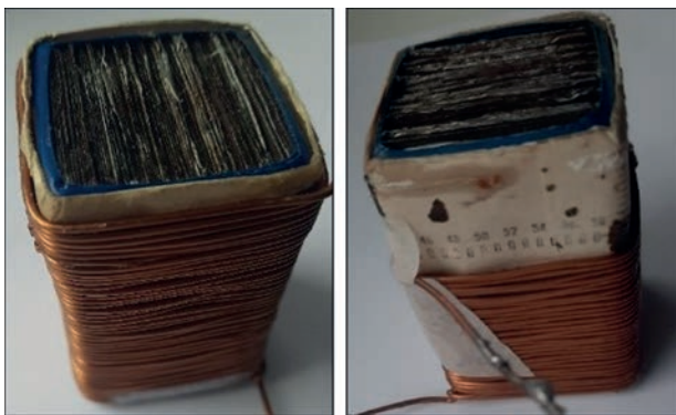
Рис. 2. Імпульсний магніт для ЕМАП з шихтованим осердям 36 \times 36 \times 60 \text{ мм}^3 з обмоткою 45 та 15 витків мідним дротом діаметром 1,2 мм
