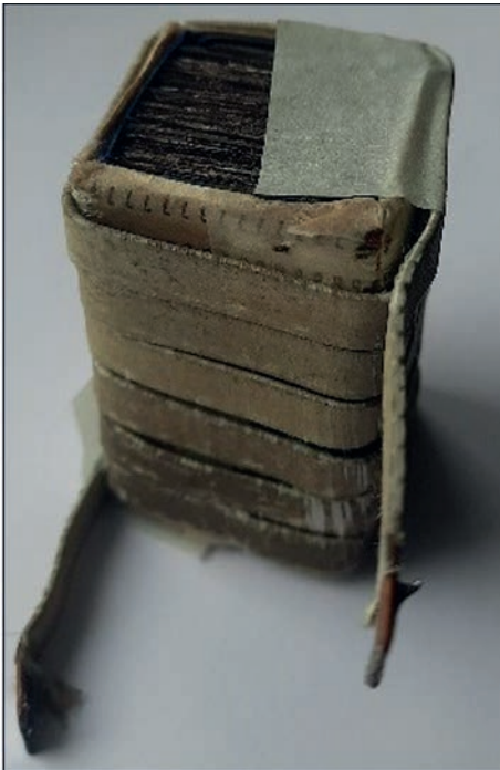
Рис. 6. Макет імпульсного магніту з котушкою з мідної шини 10 \times 1 \text{ мм}^2 ; 6,75 витків
