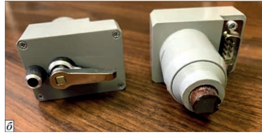
Рис. 6. Принцип вимірювання середніх наскрізних по товщині (об'ємних) напружень (ехо-імпульсних) і перетворювачі для вимірювання поздовжньої та поперечної складових середніх наскрізних товщинних (об'ємних) напружень
