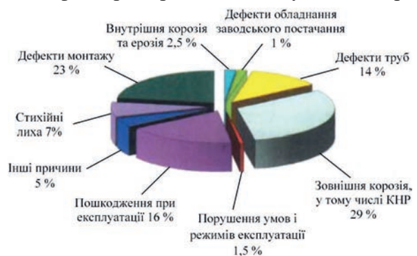
Рис. 1. Основні причини відмови трубопроводів
