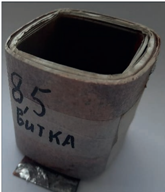
Рис. 4. Обмотка імпульсного магніту 8,5 витків, що виконана зі стрічки 60×0,5 мм 2 по висоті шихтованого осердя 60 мм розміром 36×36 мм 2
