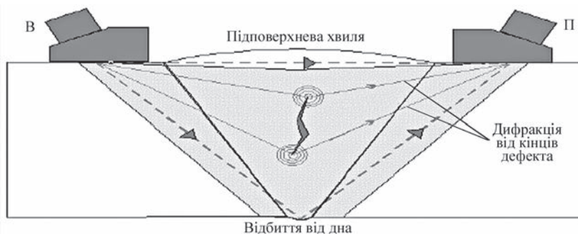
Рис. 1. Схема контролю дифракційно-часовим методом
