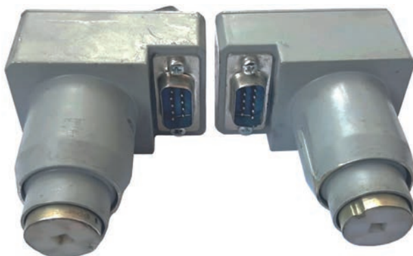
Рис. 8. Чотириполюсні перетворювачі для вимірювання поверхневих і підповерхневих напружень
