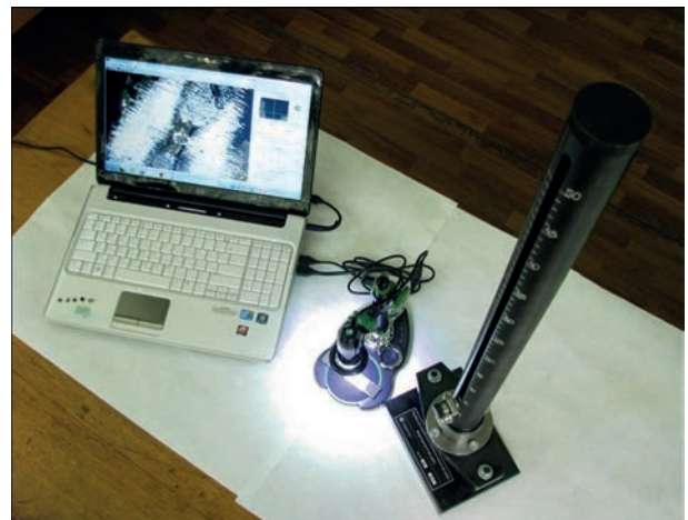
Рис. 5. Комплекс «ВК-1» для проведення досліджень і контролю якості індикаторних матеріалів для виявлення механічних пошкоджень
