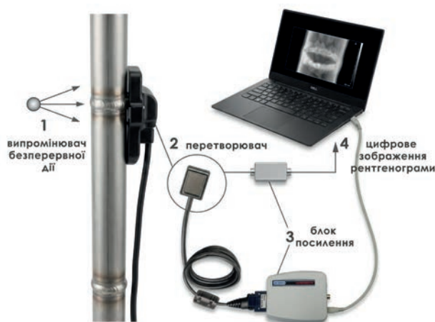
Рис. 6. Типова система для рентгенотелевізійного контролю
