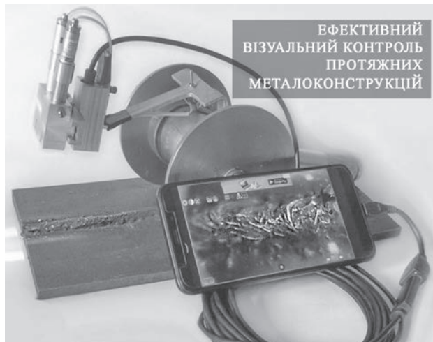
Рис. 13. Рухома магнітна платформа з відеокамерою для візуально-вимірним контролем Описане вище обладнання з РТК, НЧ УЗК, ВВК розроблено в ІЕЗ ім. Є.О. Патона НАН України, є працездатним та чекає на своїх замовників.
