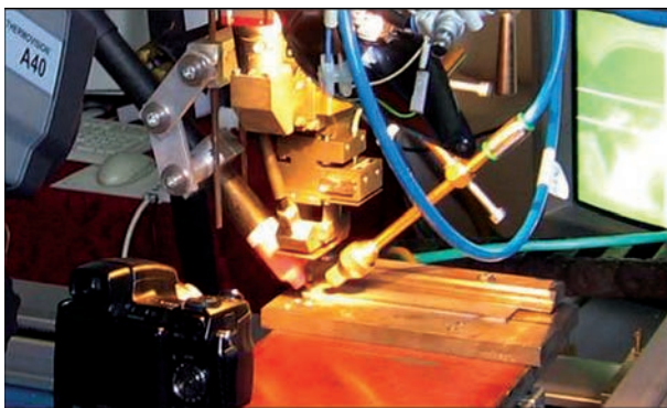
Рис. 7. Приклад системи контролю технологічного процесу гібридного лазерно-дугового зварювання за допомогою термографічної камери [1]
