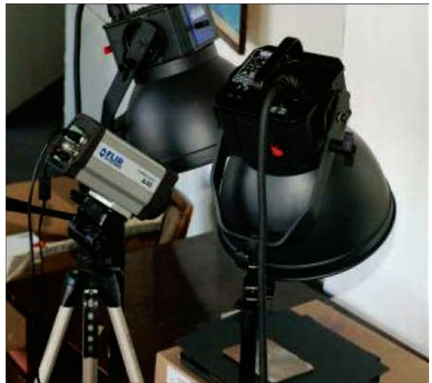
Рис. 6. Приклад системи активного термографічного контролю з використанням двох ламп-спалахів [1]
