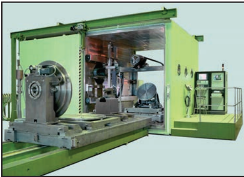
KL 115 mashine: 36 m³, 60 kV, up to 60 kW
